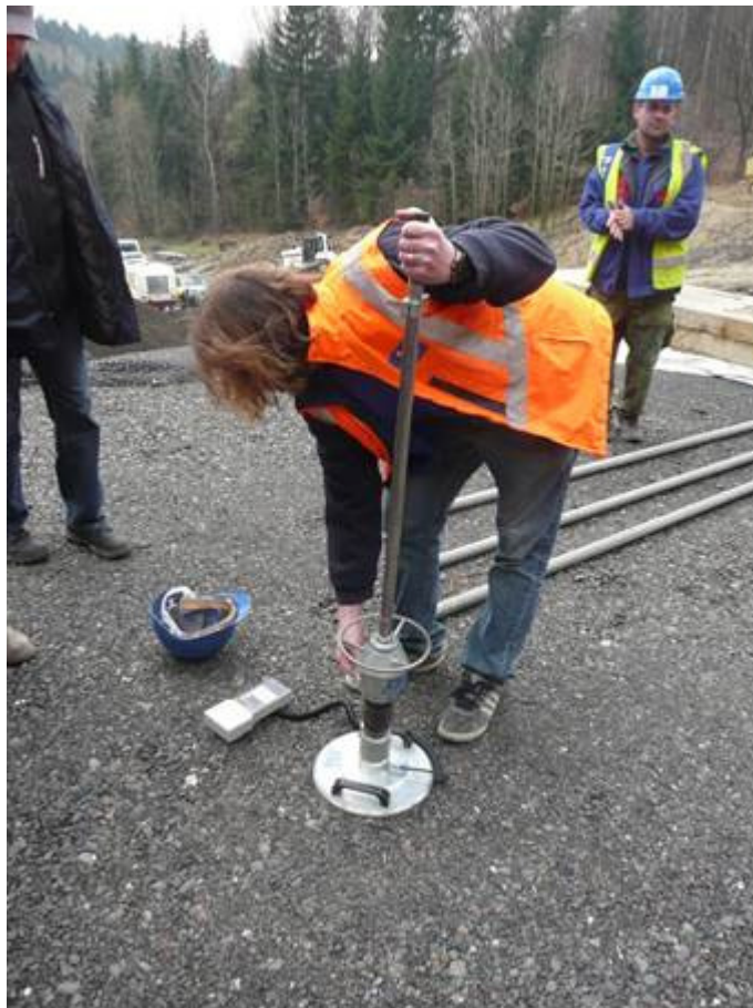
Ukázka rázové dynamické zatěžovací zkoušky.
